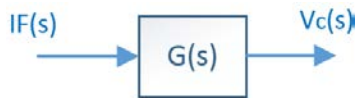
Figura 2.8: Bloque de función de transferencia de un circuito eléctrico RLC en paralelo
