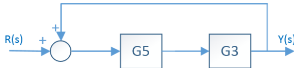
Figura 2.17: Diagrama de bloques simplificado en G5 .
