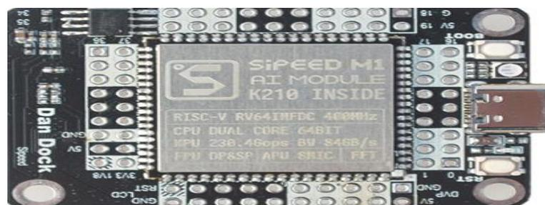
Microcontrolador fabricado por SIPEED de 64 bits con filtrado inteligente, FPU FFT incorporado.
