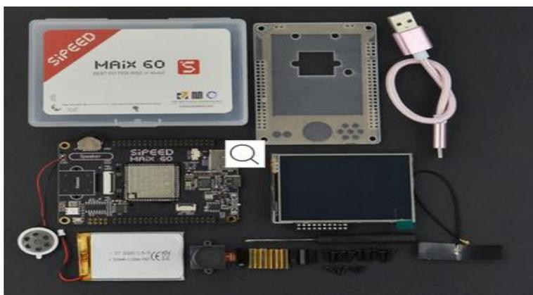
El prototipo MAIX GO de SIPEED con todas sus partes sin ensamblar y los componentes adquiridos para implementar el algoritmo. (ROBOT, 2018)
