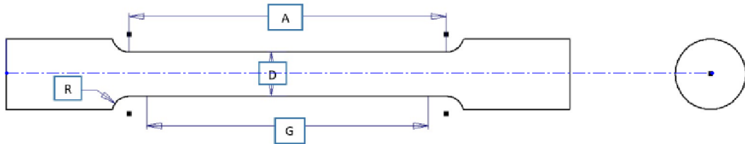
Figura 8. Dimensiones de las probetas de acuerdo a la norma ASTM E8 [38]
