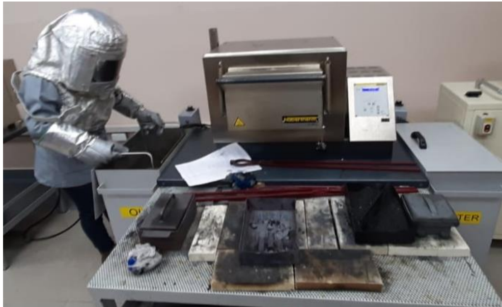
Figura 13. Horno N7/H NABERTHERM utilizado para temple
