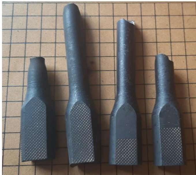
Figura 17. Ruptura de acero en estado de suministro sometido al ensayo de tracción
