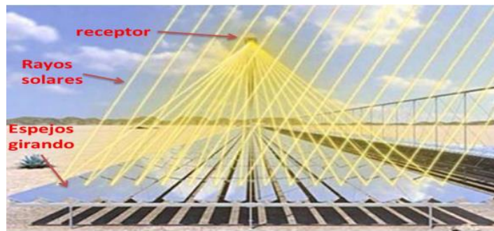
Colector Fresnel en la planta de Lozano. Fuente: (Granados, 2018)
