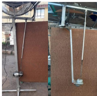
Motores acoplados a tornillos de potencia. Fuente: (Autores, 2020)
