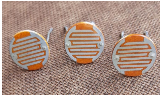
Fotorresistencias GL205. Fuente: (Autores, 2020)
