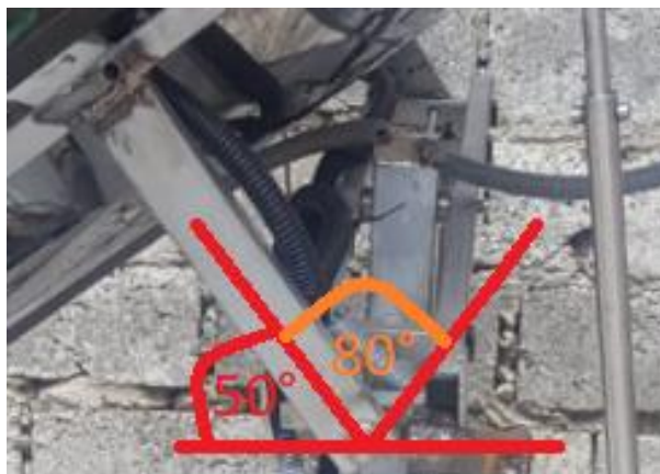
Grados de libertad del movimiento Norte- Sur. Fuente: (Autores, 2020)
