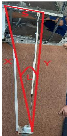
Figura 3. 14 Diagrama formado por los componentes de la estructura del colector para el actuador norte-sur
