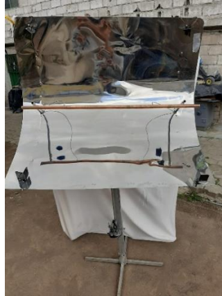
Instalación de los elementos en la estructura del colector. Fuente: (Autores, 2020)
