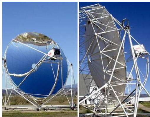
Planta colector disco parabólico Fuente: (Lozano, 2019)
