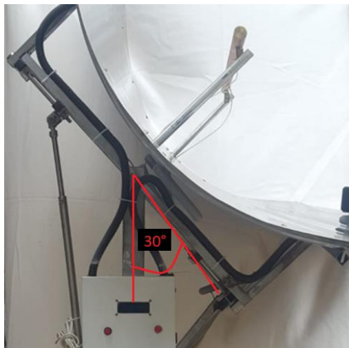
Seguidor solar en su posición final a 30^\circ . Fuente: (Autores, 2020)
