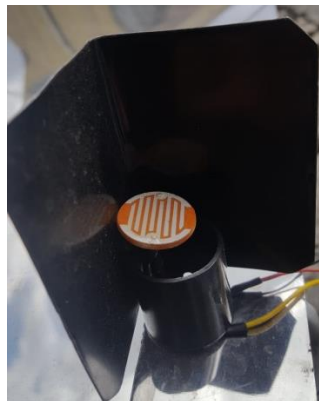
Fotorresistencia con su respectivo limitador de Radiación. Fuente: (Autores, 2020)
