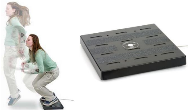
Figura 1.14 Plataforma de fuerza o dinamométrica [19].
