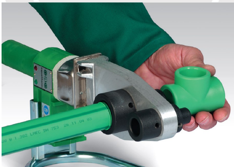
Figura 2.3 Fusión de la tubería con el accesorio (Aquatherm, 2015)
