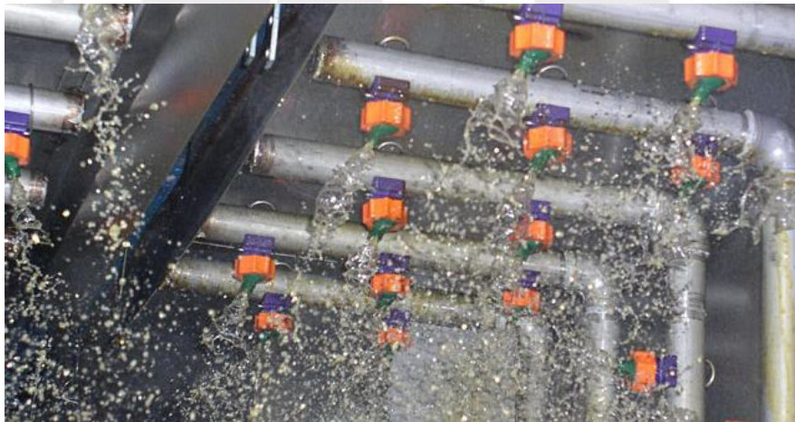
Figura 2.7: Aspersores aplicando fluido de plañorización.
