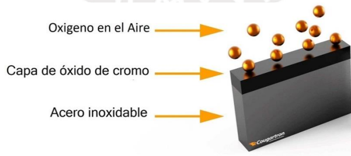
Figura 2.4: Ejemplo de pasivación. Capa de óxido de cromo para proteger el acero inoxidable.
