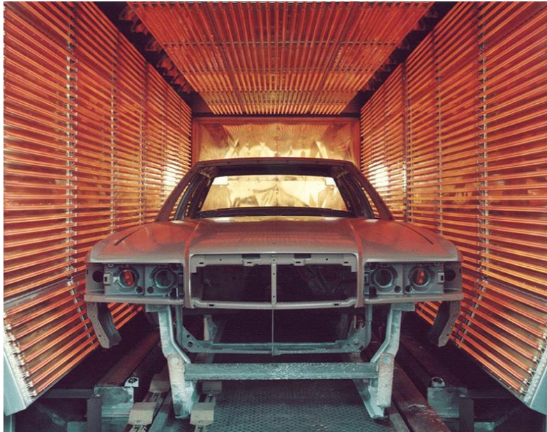
Figura 2.9: Carrocería de un auto dentro de un horno de curado de lámparas eléctricas infrarrojas.
