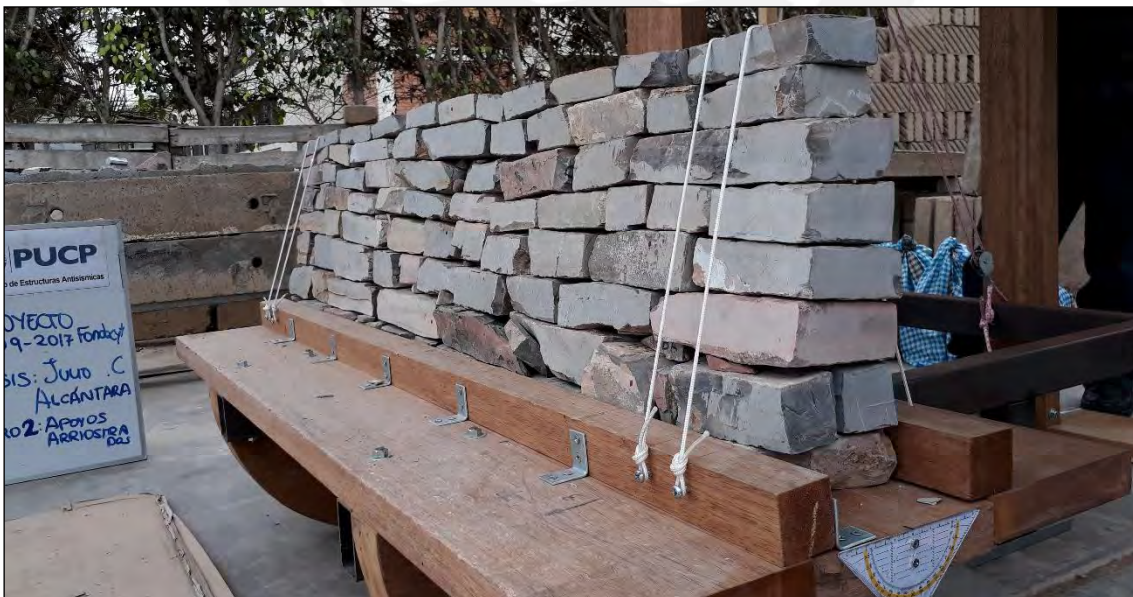
Figura 32. Especimen con arriostres instalados en ambos extremos
