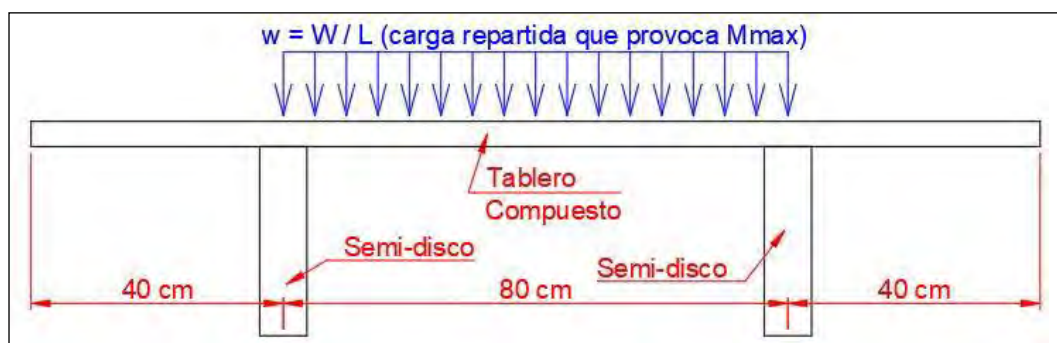
Figura 24. Distribución de cargas en tablero
