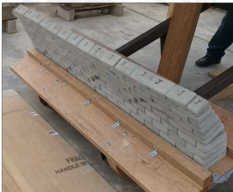
Figura 35. Instante de falla de muro de bloques regulares sin arriostres (2do ensayo)
