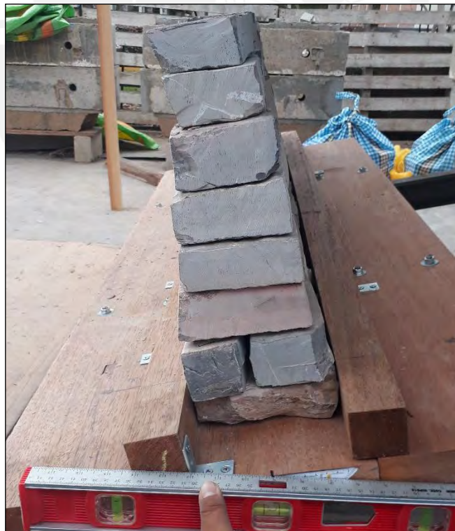
Figura 40. Vista de muro de bloques irregulares sin arriestre – inclinación de 10^\circ (3er ensayo)
