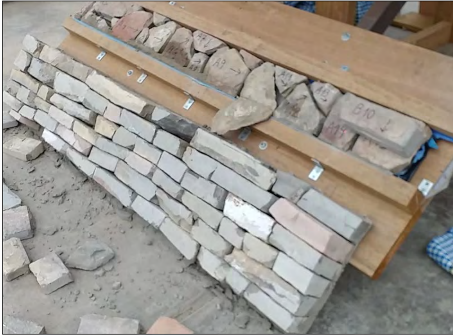
Figura 39. Instante de falla de muro de bloques irregulares con tarrajeo (1er ensayo)
