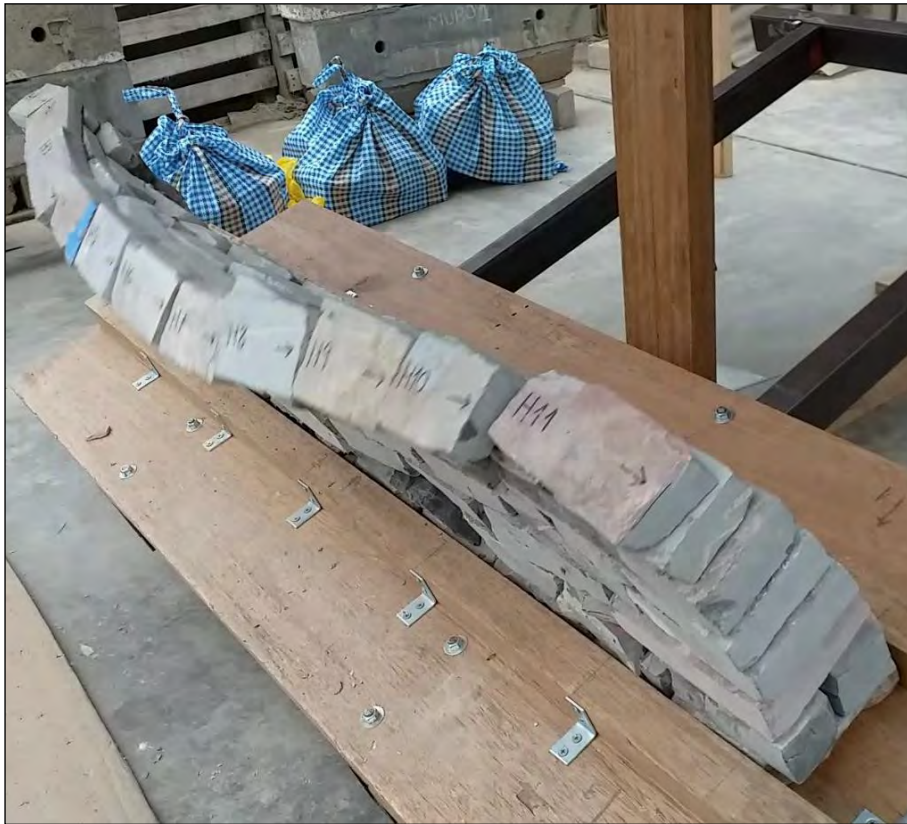
Figura 37. Instante de falla de muro de bloques irregulares sin arriostres (3er ensayo)
