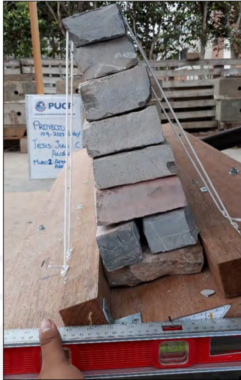
Figura 41. Vista de muro de bloques irregulares con arrioste – inclinación de 15^\circ (2do ensayo)
