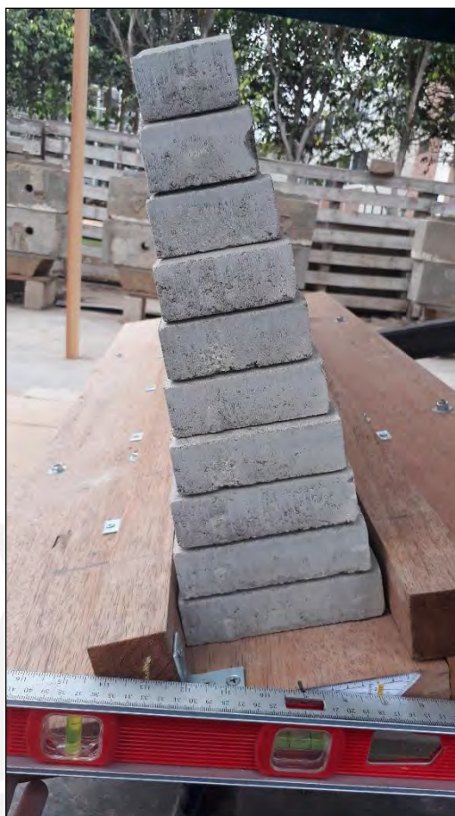
Figura 36. Vista de muro de bloques regulares sin arriostres – inclinación de 15° (2do ensayo)
