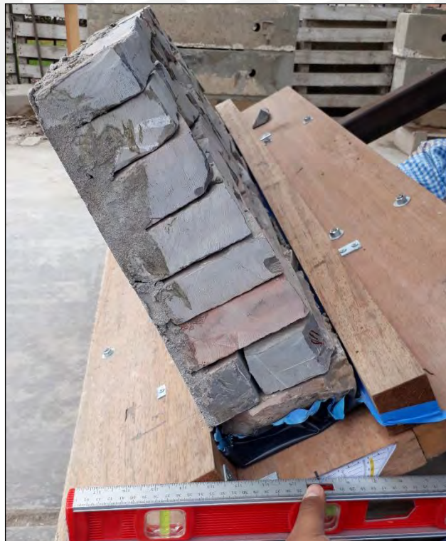
Figura 42. Vista de muro de bloques irregulares con tarrajeo – inclinación de 30^\circ (1er ensayo)
