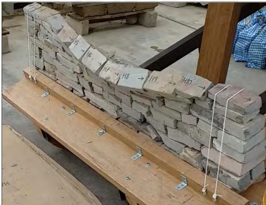
Figura 38. Instante de falla de muro de bloques irregulares con arriostres (2do ensayo)
