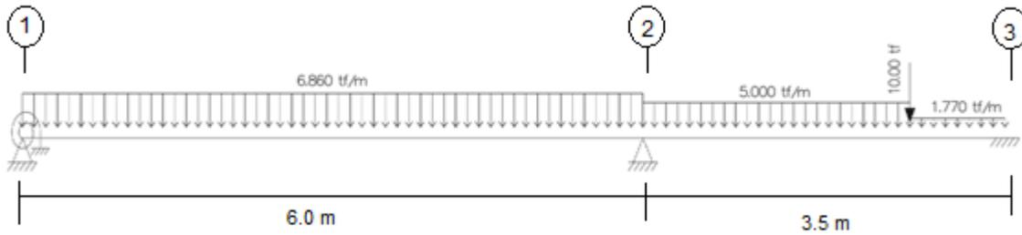
**Figura 4.5. Cargas en viga eje C**
