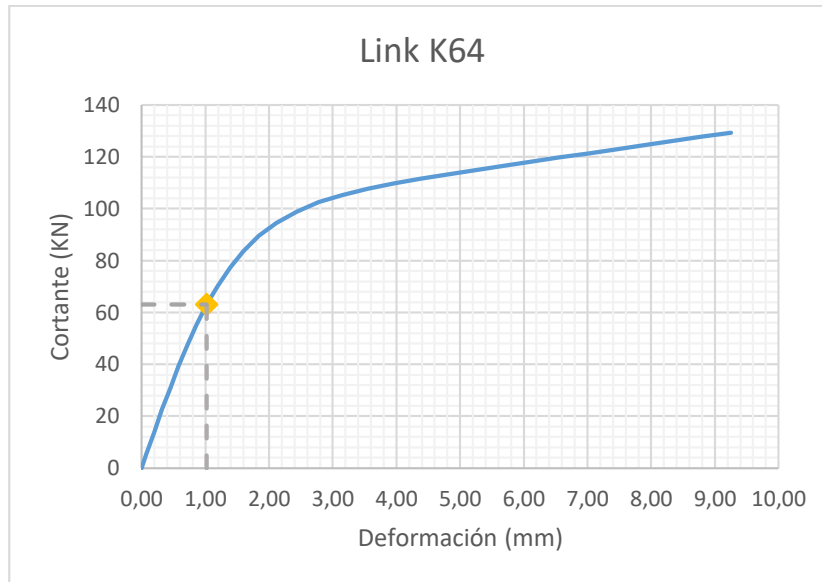
Figura 5.6 Curva de deformación disipador K64 en el Pushover
