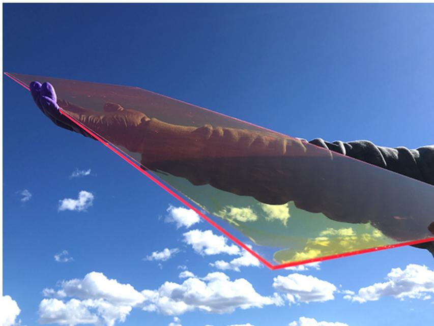
FIGURA 9.1: Fotografía de vidrio modificado con QDots que actúan como concentradores de luz luminiscentes. Le emisión fluorescente de los nanocristales puede ser conducida por reflexión total interna hasta un dispositivo fotovoltaico.
