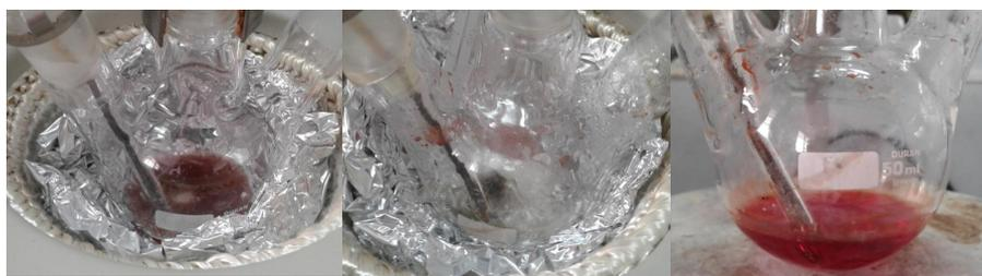
FIGURA 5.3: De izquierda a derecha: Foto de la mezcla de CdO, OPDA y TOPO a temperatura ambiente; Foto de la misma mezcla a  $350^{\circ}\text{C}$ ; Foto tomada luego de la inyección del precursor de TOPSe y 20s de reacción
