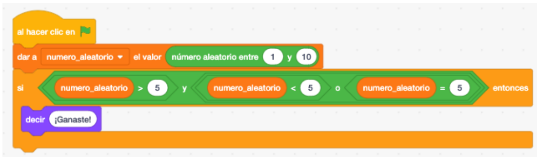
Figura 3.7: Programa creado en Scratch con error lógico en la condición.
