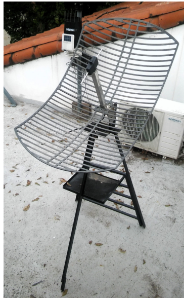
Figura 33: Dipolo con su reflector en la terraza del IATE.
