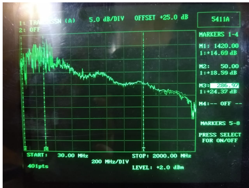
Figura 52: Respuesta del LNA en frecuencia entre 30 MHz y 2000 MHz. Hay punteros en el gráfico que están indicando el valor en ganancia para 50 MHz, 286.97 MHz y 1420 MHz.
