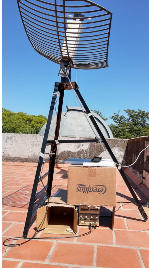
Figura 86: Sistema de medición con la nueva fuente de alimentación del LNA.
