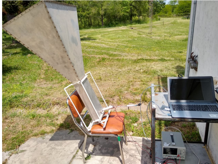
Figura 53: Disposición del sistema para medir HI galáctico. La medición se realizó en el predio del IAR que se encuentra alejado de las ciudades cercanas.
