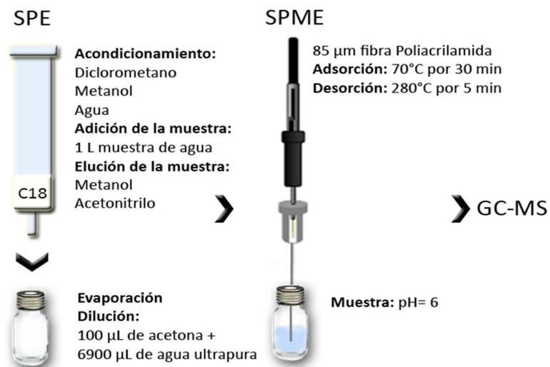
Figura 1.6: Esquema de la extracción combinada de SPE y SPME para la determinación de plaguicidas apolares y semi-polares en aguas naturales.
