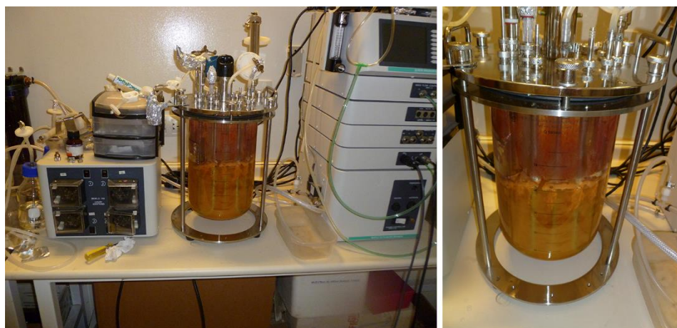
Figura 5. Producción de FB1 en biorreactor a partir de la cepa R2024 de F. verticillioides .
