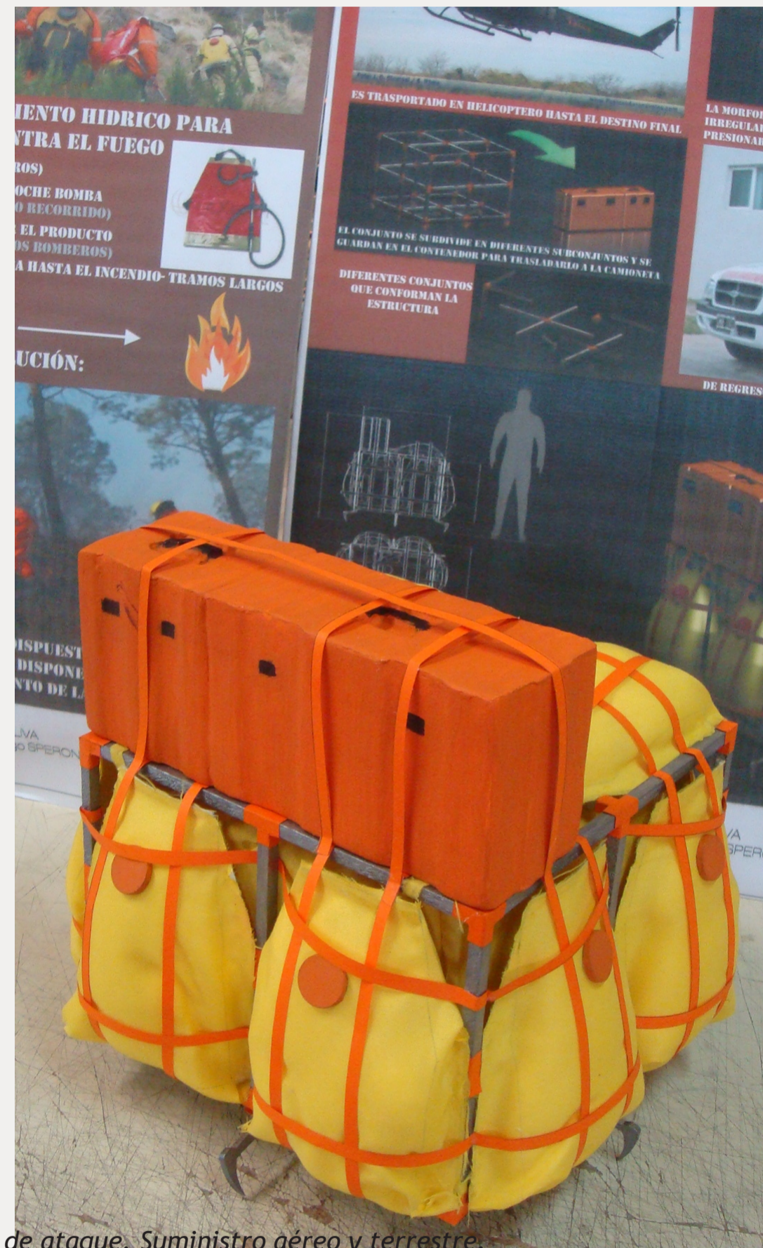
Contenedor de apoyo, soporte para reabastecimiento de agua, insumos y equipos de ataque. Suministro aéreo y terrestre.
