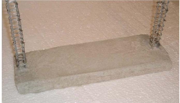
Figura 4 - Fundación hormigonada
