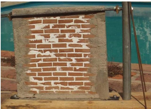
Figura 5 - Muro de micromampuestos cerámicos encadenados
