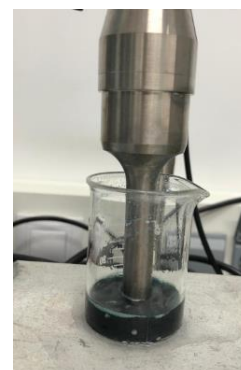
Figura 10- Aplicación de ultrasonidos de alta potencia al precursor de VO 2
