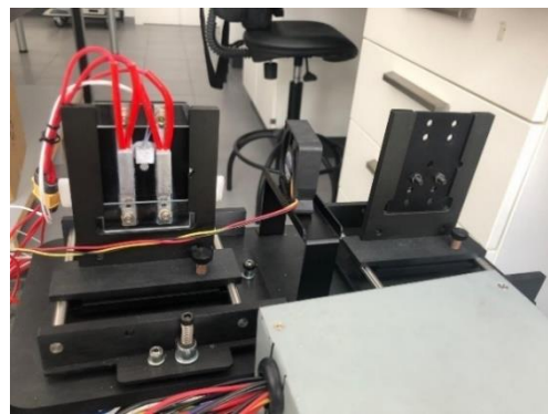
Figura 15- Soporte con el sistema de calentamiento de las muestras
