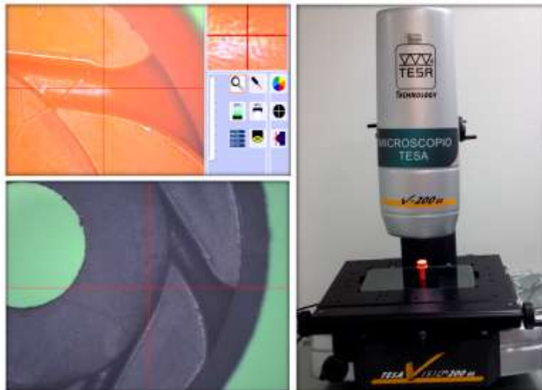
Figura 7. Medición de las toberas de entrada por microscopía
