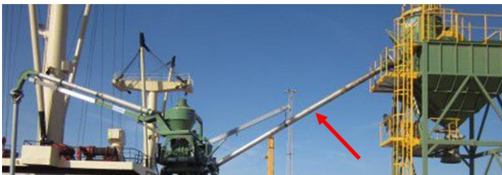
Figura 19. Transportador Neumático para descarga de cereal en buques y problema analizado en el caso de estudio 2.
