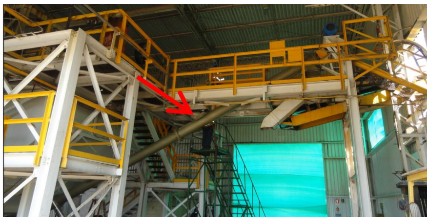
Figura 15. Tornillo transportador utilizado actualmente y problema analizado en el caso de estudio 1.
