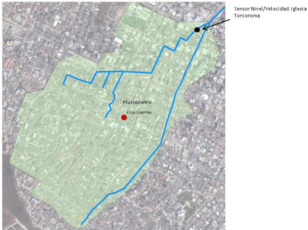
Figura 12-1. Ubicación de equipos para calibración
