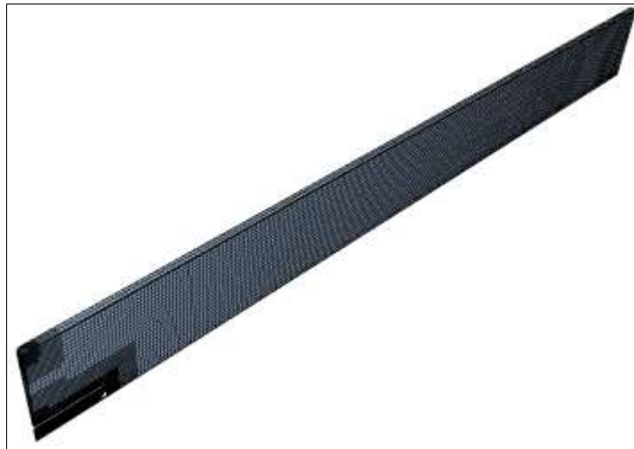
Figura 38. Malla de 35417 celdas para estudio de independencia de mado.
