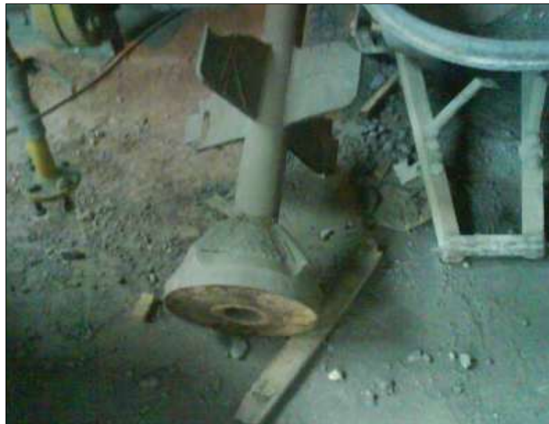
Figura 17. Tubo interno del quemador con estabilizador de llama (bluff body).
