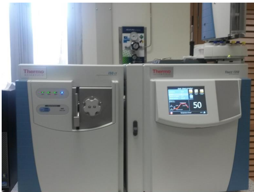
Figura 15. Sistema de análisis (lado derecho cromatografo de gases, lado izquierdo espectrometro de masas)
