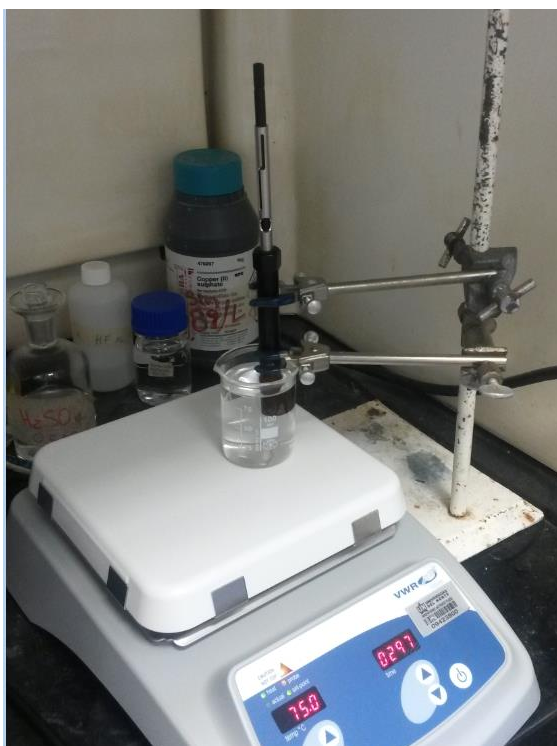
Figura 14. Montaje para extracción de analitos por SPME
