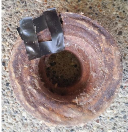
Figura 45 Muestra de acero oxidado para medición de precisión de emisividad
