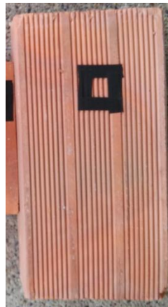
Figura 35 Configuración para medición de emisividad aplicando el método 2
