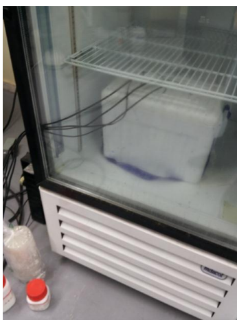
Figura 32 Montaje para medición de calor específico usando el método 3
