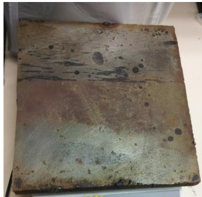
Figura 43 Muestra de acero A36 para medición de la precisión del método de medición de calor específico
