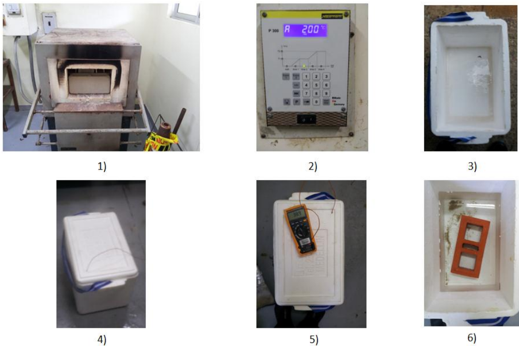
Figura 29 Pasos para medición de calor específico usando el método 1
