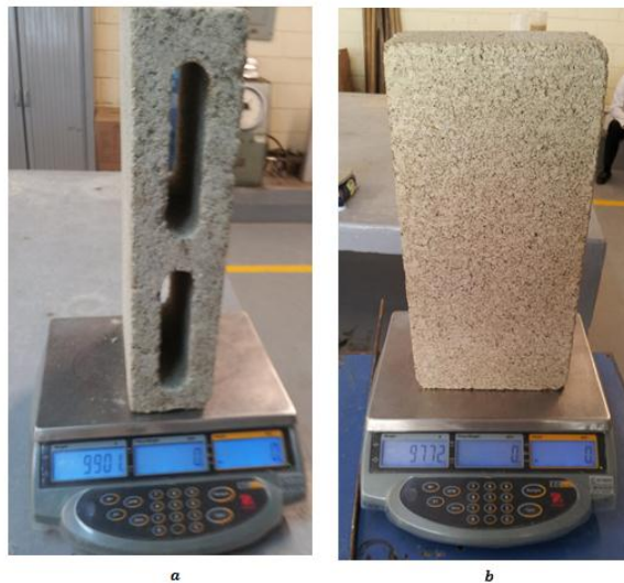
Figura 53 a) Masa del material bloque liso en condiciones de equilibrio de humedad b) Masa del material de bloque liso luego del proceso de secado
