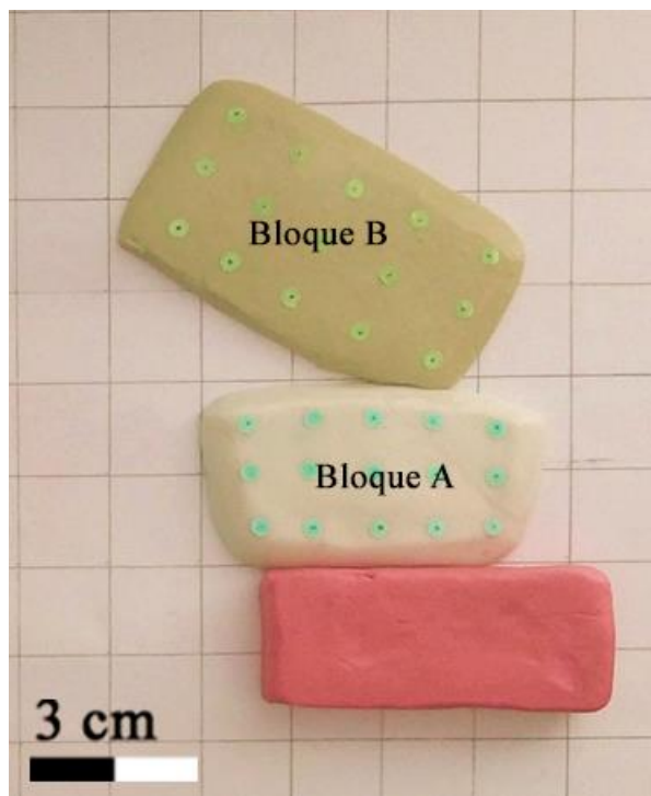
Figura 1. Configuración inicial de los materiales. El bloque B se desliza sobre la superficie inclinada por acción gravitacional hasta colisionar con el bloque A. La plastilina funciona como anclaje para evitar que el bloque B también se deslice.
