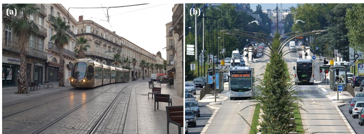
Figura 1.2. Ejemplos de las dos principales clases de sistemas de transporte público urbano y metropolitano de capacidad intermedia: a) Tranvía moderno en Montpellier (Francia); b) Sistema de autobuses semirrápidos sobre plataforma reservada (BHL o BRT) en Nantes (Francia).
