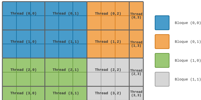
Figura 4.4: Superposición dos fíos do grid sobre os píxeles da imaxe.
