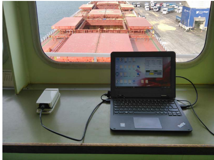
Figura 7. IMU y ordenador de control y almacenamiento de datos instalados en el interior del puente de mando de un buque.
