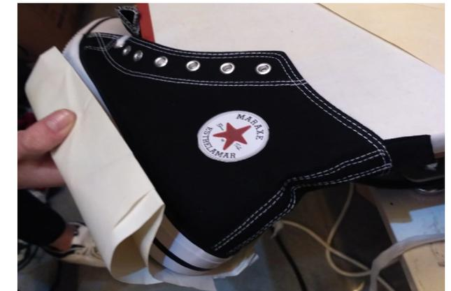
*Plancha de calor adaptada a la forma de la zapatilla.*
