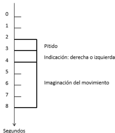
Figura 1: Trama del paradigma de imagen motora. Los primeros dos segundos el sujeto está relajado. A los dos segundos suena un pitido y a continuación suena una indicación sonora del lado a imaginarse.
