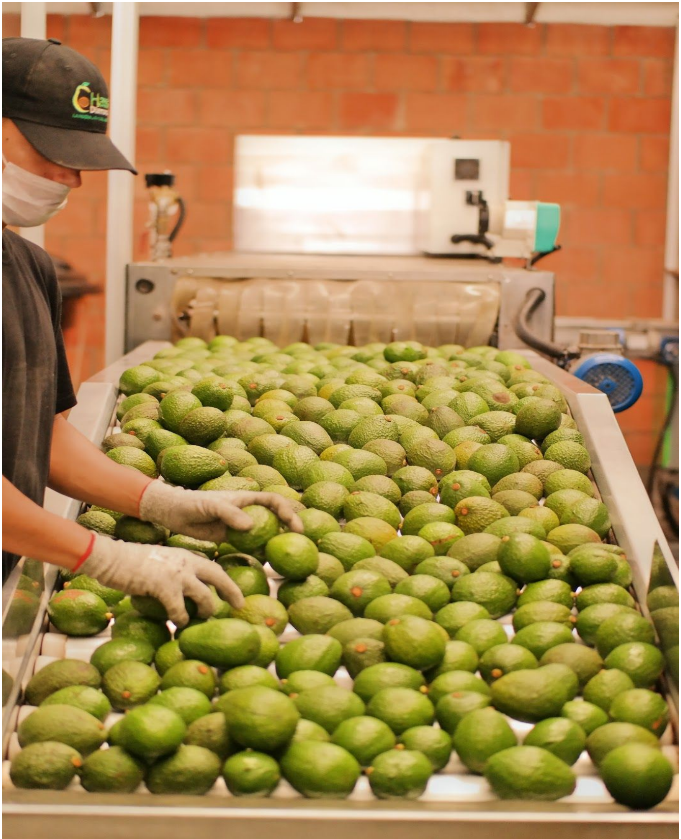
Imagen 2, báscula para la clasificación del aguacate por peso en la empresa Hass Diamond. Fuente:
