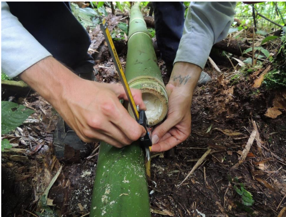
Imagen 13. Medición de Paredes de la Basa. Jardín Botánico, UTP. Fuente: Propia
