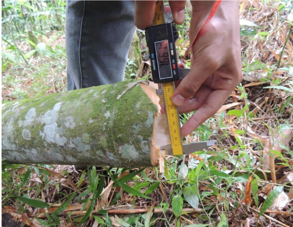
Imagen 2. Medición de Diámetro Interno de la Basa. Yarima Guadua Fuente: Propia
