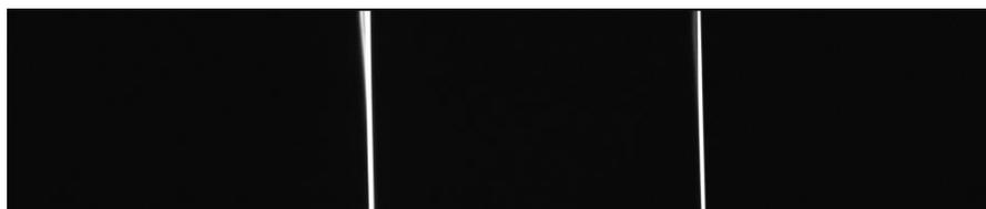
(c) Espectro de emisión del gas He centrado en la posición 10.40 mm del tornillo micrométrico
