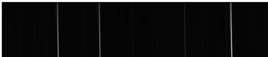
(a) Espectro de emisión del gas Hg centrado en la posición 10.40 mm del tornillo micrométrico
