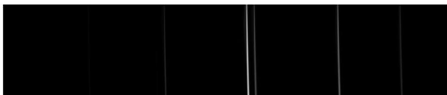
(b) Espectro de emisión del gas Hg centrado en la posición 10.80 mm del tornillo micrométrico
