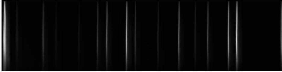
Figura 3.16: Espectro de emisión del gas Ne centrado en la posición 09.10 mm del tornillo micrométrico
