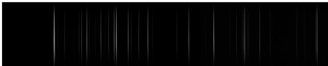
Figura 3.21: Espectro de emisión completo del gas Ne en el rango visible
