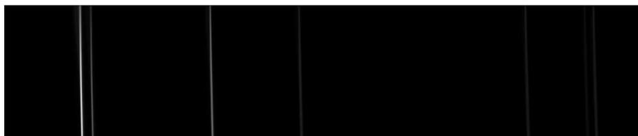
(c) Espectro de emisión del gas Hg centrado en la posición 11.20 mm del tornillo micrométrico
