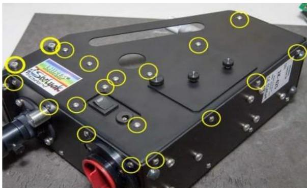
Figura 3.22: Extracción carcasa lateral
