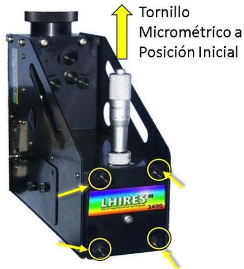
Figura 3.11: Primer paso extracción rejilla de difracción
