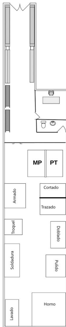
Ilustración 29 Distribución de Planta
