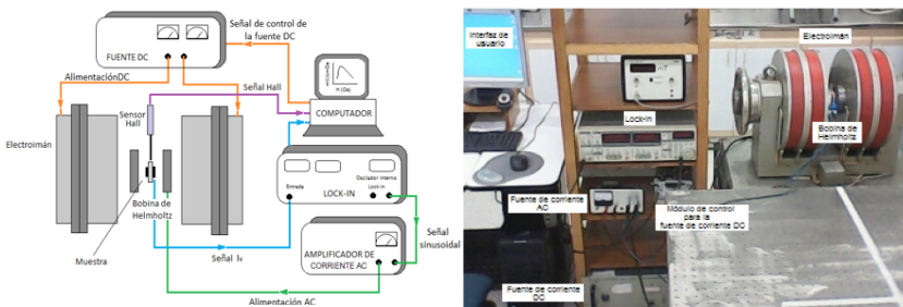
Figure 6. (a) Esquema y (b) Montaje experimental del sistema de medidas magnetoeléctricas operando a temperatura ambiente implementado en la UTP [22]
