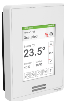
Figura 5.2: Interface Homem-Máquina instalada na Test Room 2 que permite estabelecer os setpoints dos sistemas de arrefecimento e aquecimento. Funciona também como sensor de temperatura e humidade relativa. (Retirado de Schneider Electric, 2020b).
