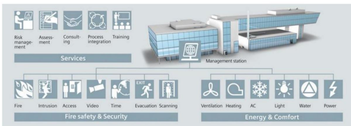
Figura 2.4: Exemplo de uma possível solução Total Building Solutions . (Retirado de Siemens, 2016a).
