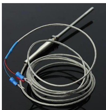
Figura 5.8: Sensor de temperatura instalado em cada registo do sistema BIPV da Test Room 2 .
