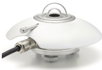
Figura 5.5: Sensor instalado no exterior da Test Room 2 , que mede a radiação solar incidente na fachada.
