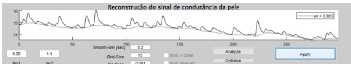
Figura 4-5 Sinal de EDA sem ajuste das fases tónica e fásica.
