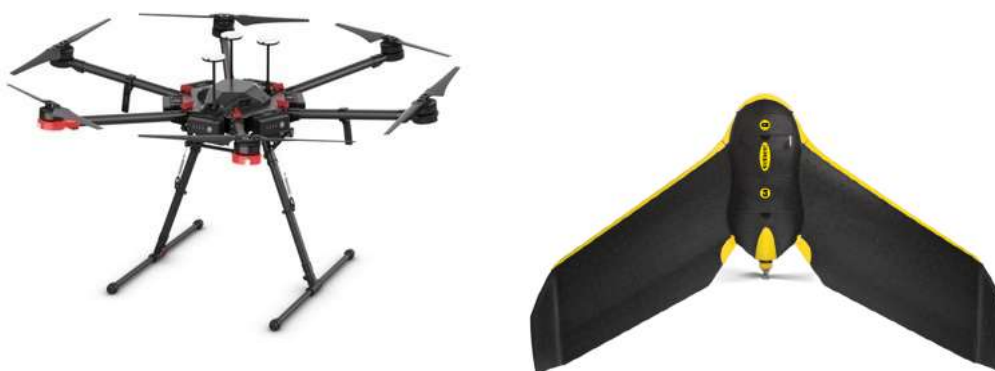
FIGURA 2.1: a) VANT de asa rotativa; b) VANT de asa fixa Fonte: (DJI, 2017; SenseFly, 2019)
