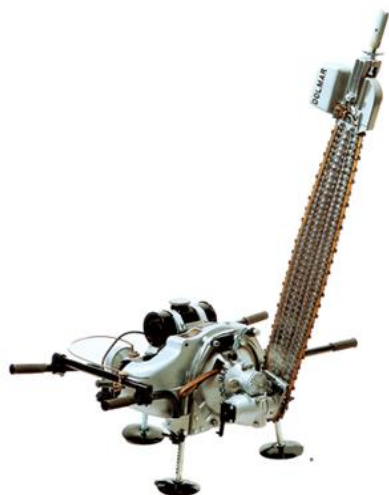
Figura 4- Primeira motosserra com combustão a gasolina (Fonte: Dolmar.pt)
