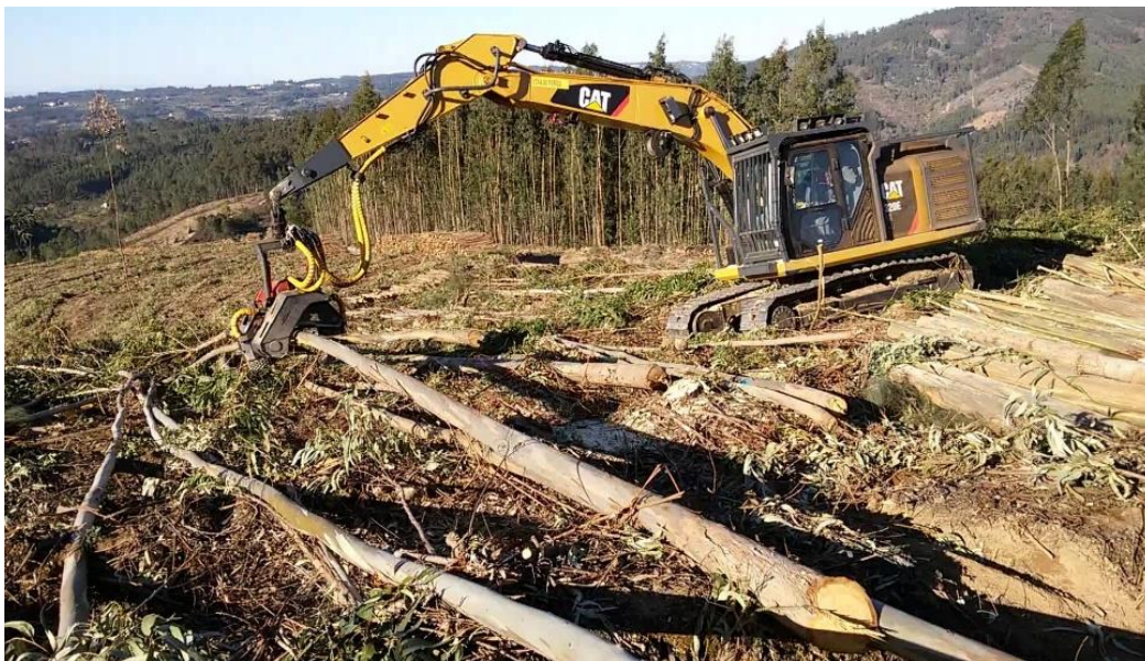
Figura 12- Processamento mecanizado de corte com abate manual (Fonte: ffernandes.pt)
