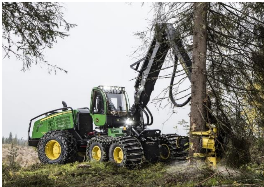
Figura 13- Abate direto com harvester (Fonte: https://www.deere.co.za )
