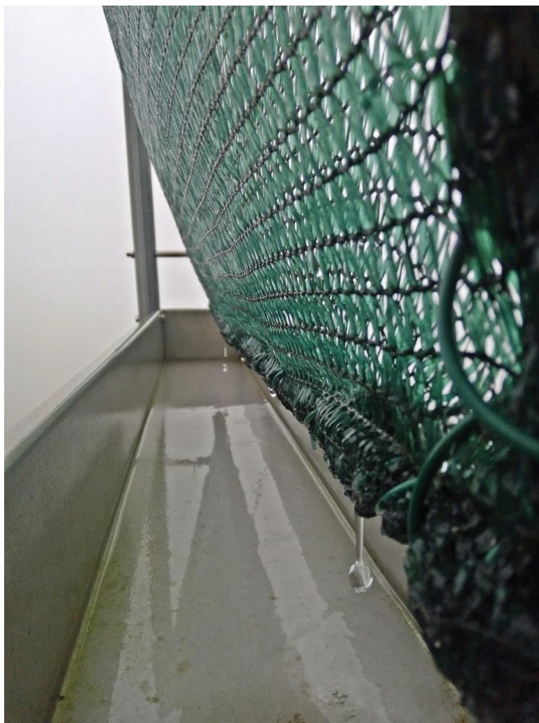
Figura 5.7 – Pormenor do dispositivo Standard Fog Collector , captando nevoeiro (25 de agosto de 2019).
