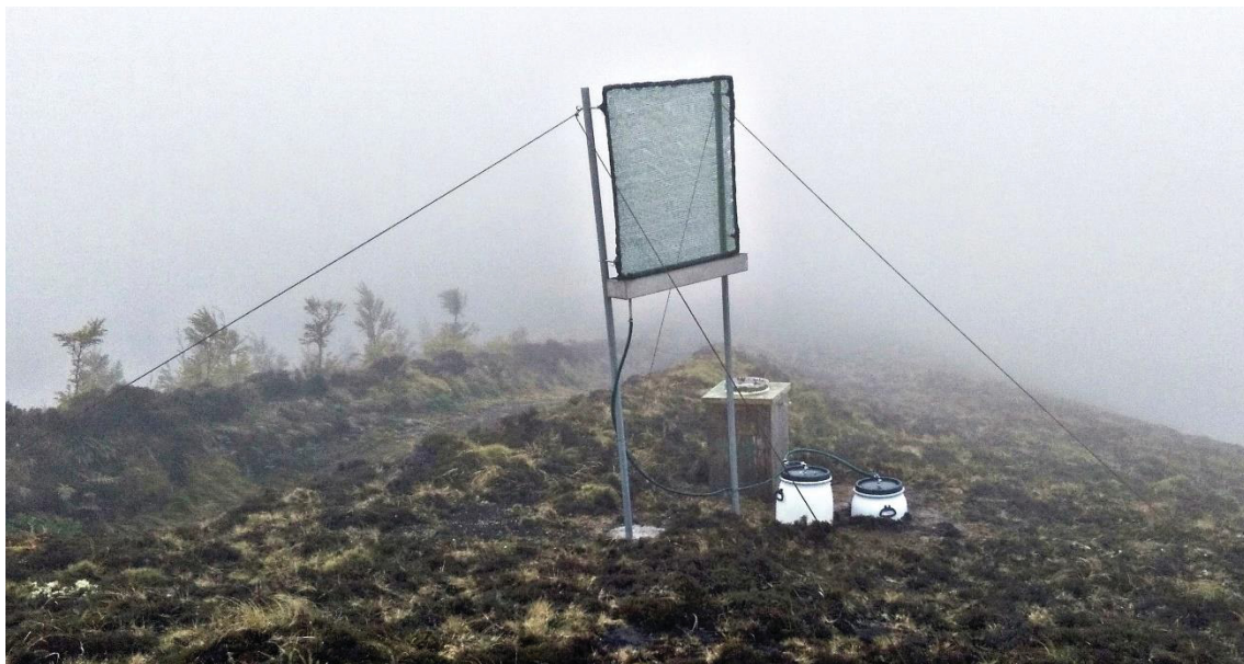
Figura 5.5 – Dispositivo Standard Fog Collector segundo Shemenauer & Cereceda (1994) em dia de nevoeiro
