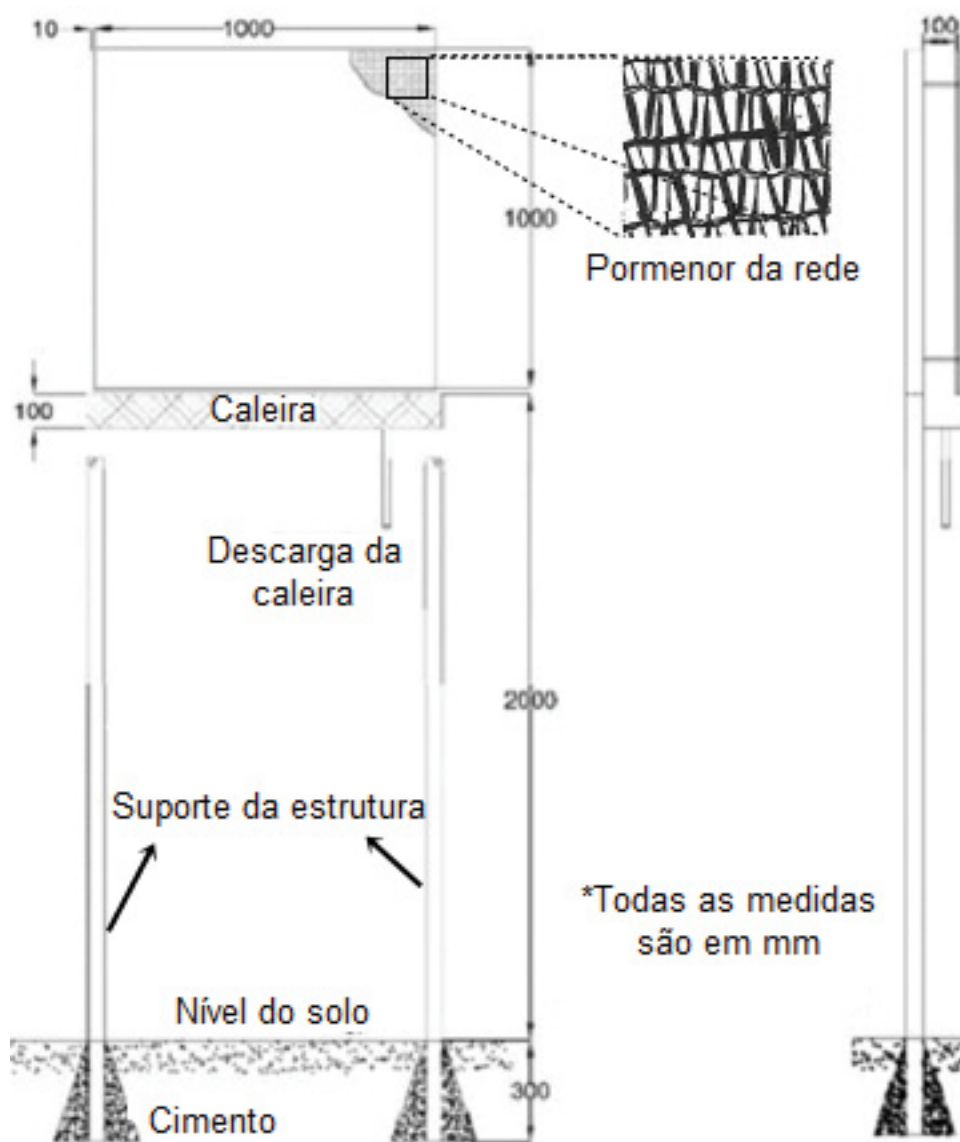
Figura 5.4 – Dispositivo Standard Fog Collector segundo Shemenauer & Cereceda (1994).
