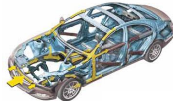
Figura 4 – Ligações adesivas no Mercedes CLS [8]
