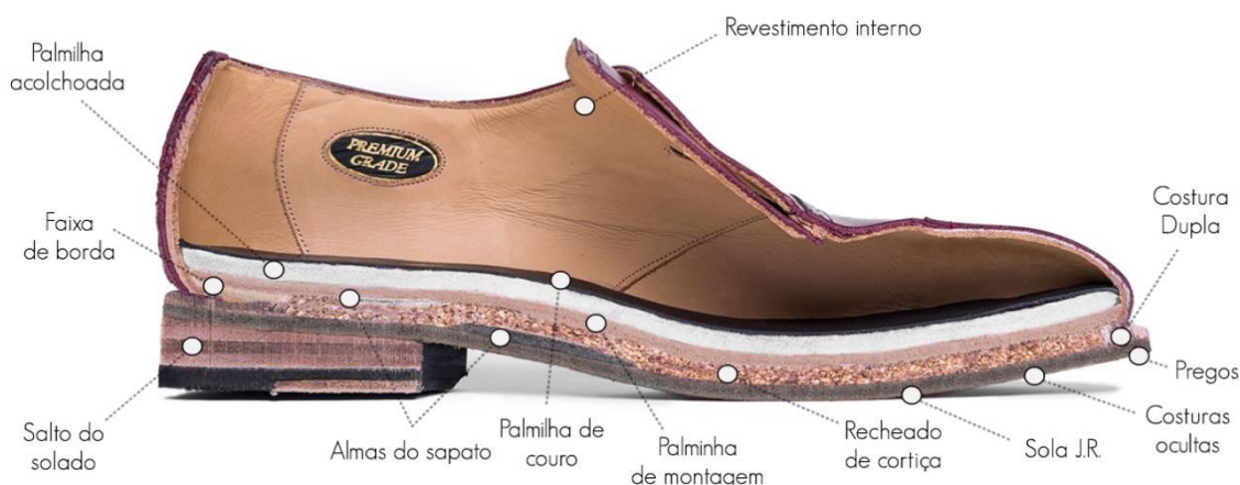
Figura 7 - Principais componentes de um sapato [13]
