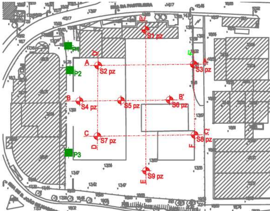
Figura 4.44 – Projeto Geotécnico – (Fonte: Projeto de Geotecnia, 2019)
