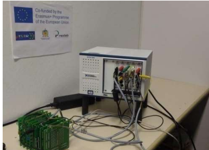
Figura 1 - Módulo VISIR instalado no RExLab
