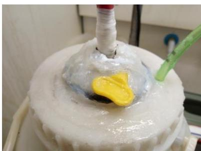
**Figura 42:** Imagem da área superior do biodigestor experimental de Bancada com revestimento de cola quente e cola de silicone e celofane recobrimdo a pá do rotor [190].
