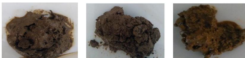
**Figura 30: Frações de argila, silte e areia após peneirarem. A imagem superior esquerda, representa a fração argila húmida, a superior direita, a fração silte húmida e a imagem inferior, a fração areia com reduzida quantidade hídrica [190].**
