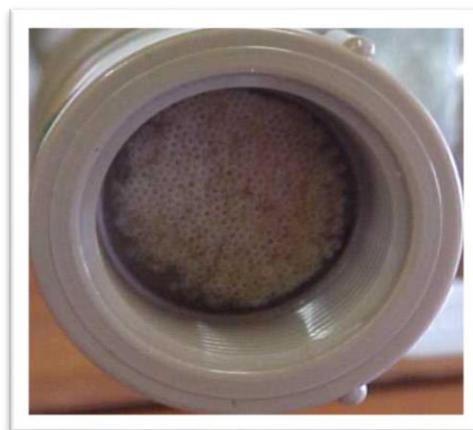
Figura 21: Membrana de metano em um tubo de poliuretano capaz de permitir a permeabilidade do  $CH_4$  [3]
