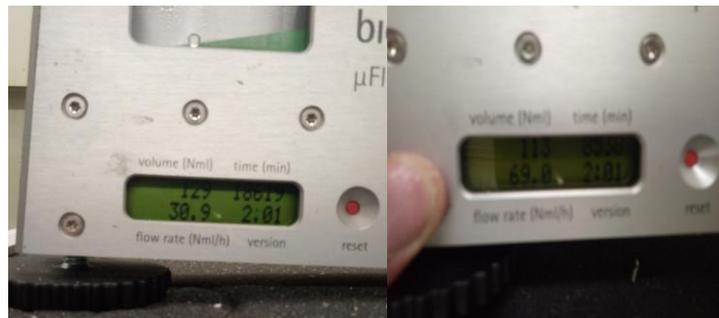
**Figura 51: Imagens dos volumes em Nml e Vazões em Nml/h de biogás produzido durante sua passagem pelo medidor de fluxo [190].**
