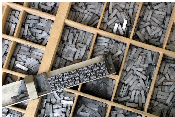
FIGURA 30: Composição de tipos móveis em montagem. Ao fundo, caixotim com compartimentos para a organização por caracteres de uma mesma família tipográfica.
