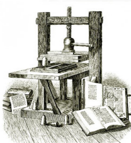
FIGURA 29: Imagem ilustrativa do primeiro prelo tipográfico desenvolvido por Gutenberg e utilizado para a impressão da bíblia de 42 linhas.
