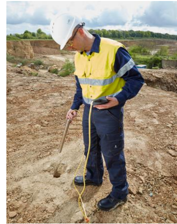
Figura 38 - Sistema Boretrak® de Barras e cbaos da Carlson. Imagens da internet:
