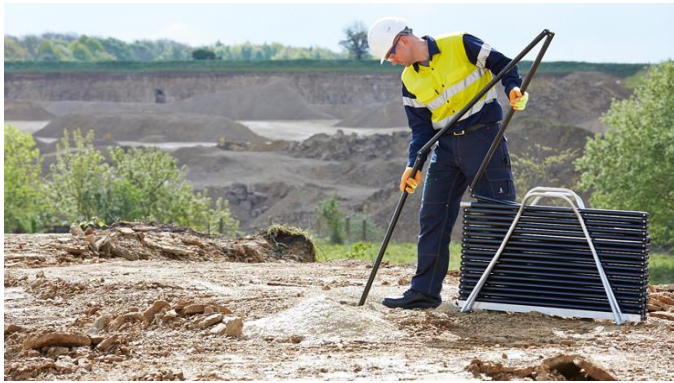
Figura 38 - Sistema Boretrak® de Barras e cbaos da Carlson. Imagens da internet:
