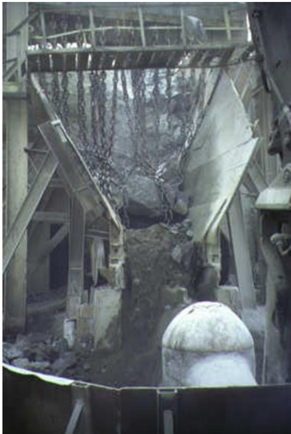
Figura 48 - Torva de alimentação ao Britador Primário, BP 38 DD, da Pedreira da Madalena (Arquivo da SOLUSEL).
