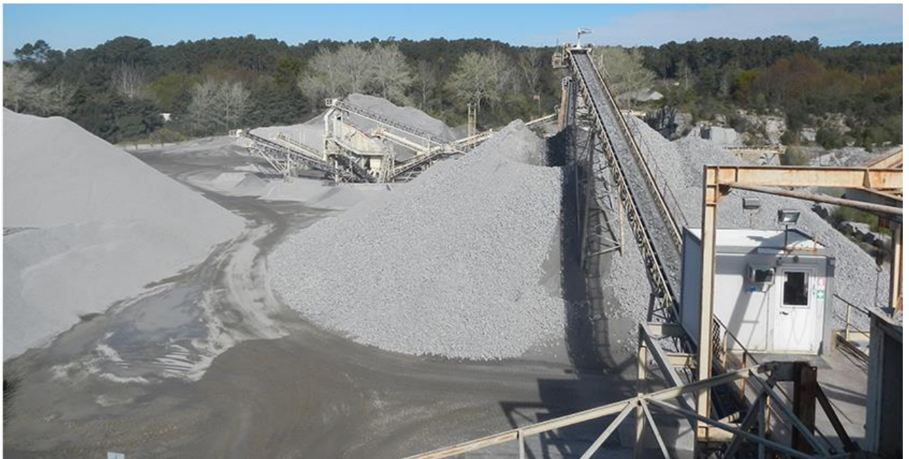
Figura 49 - Exemplo de pré-stock de material britado em britador primário. Imagem do site da Tecnovia http://tecnovia.pt/portfolio-posts/viseu/
