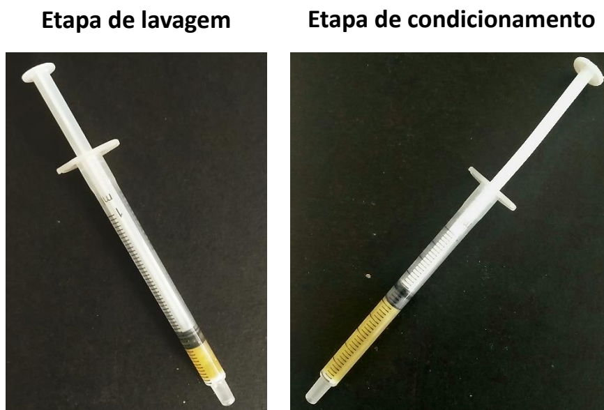
Figura 23 – Aspeto da coluna (formato 2) após lavagem com ácido (esquerda) e após condicionamento com tampão (direita).
