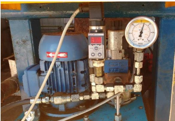
Figura 2.26 - Grupo Hidráulico do Filtro Prensa
