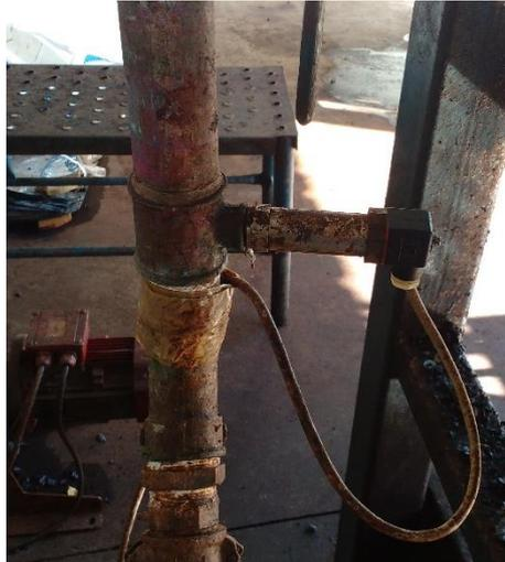
Figura 2.21 - Transdutor de pressão para a Bomba Peristáltica
