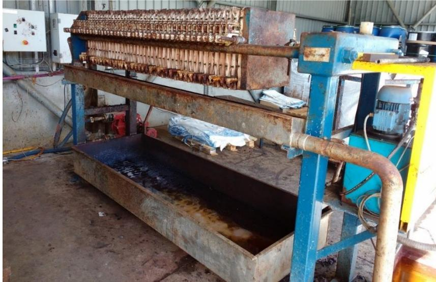
Figura 2.24 - Filtro Prensa do sistema prévio
