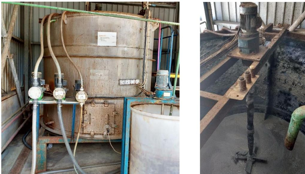
Figura 2.9 - Tanque de Mistura e Agitador
