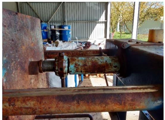
Figura 2.25 - Cilindro de simples efeito do Grupo Hidráulico do Filtro Prensa
