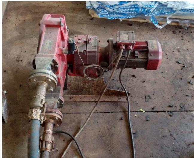
Figura 2.20 - Bomba Peristáltica, Bredel SPX40
