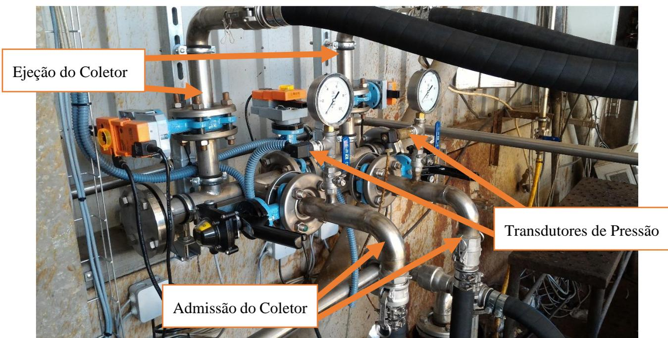
Figura 4.6 - Coletor das Bombas Peristálticas
