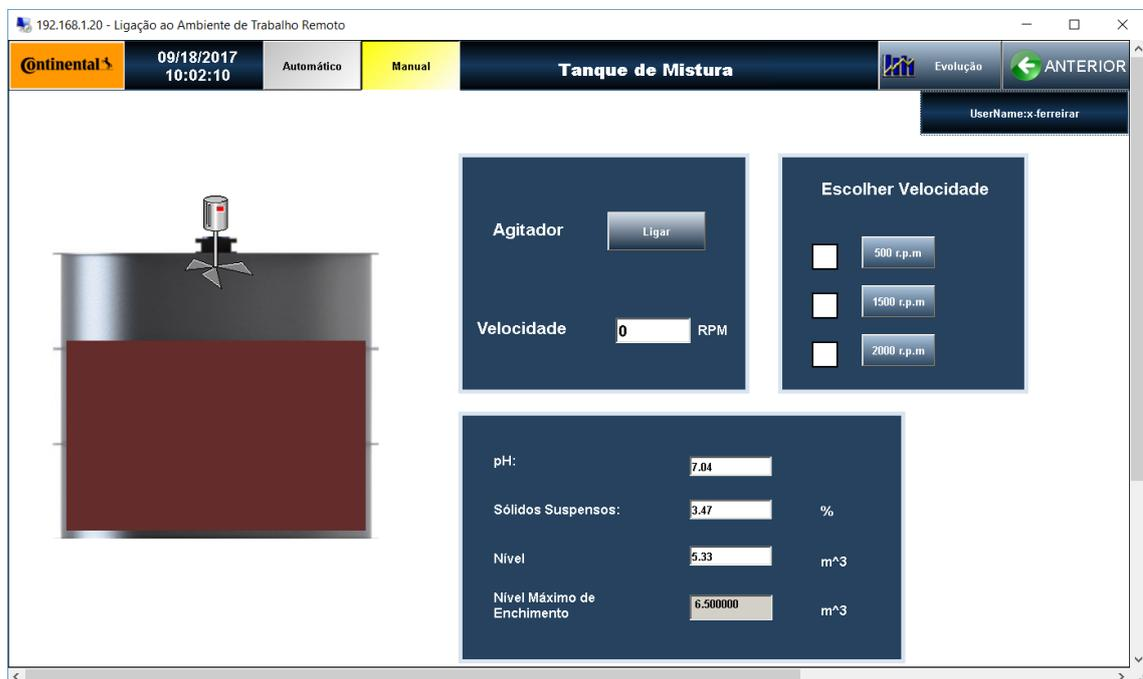
Figura 3.48 - Ecrã do Tanque de Mistura, HMI local
