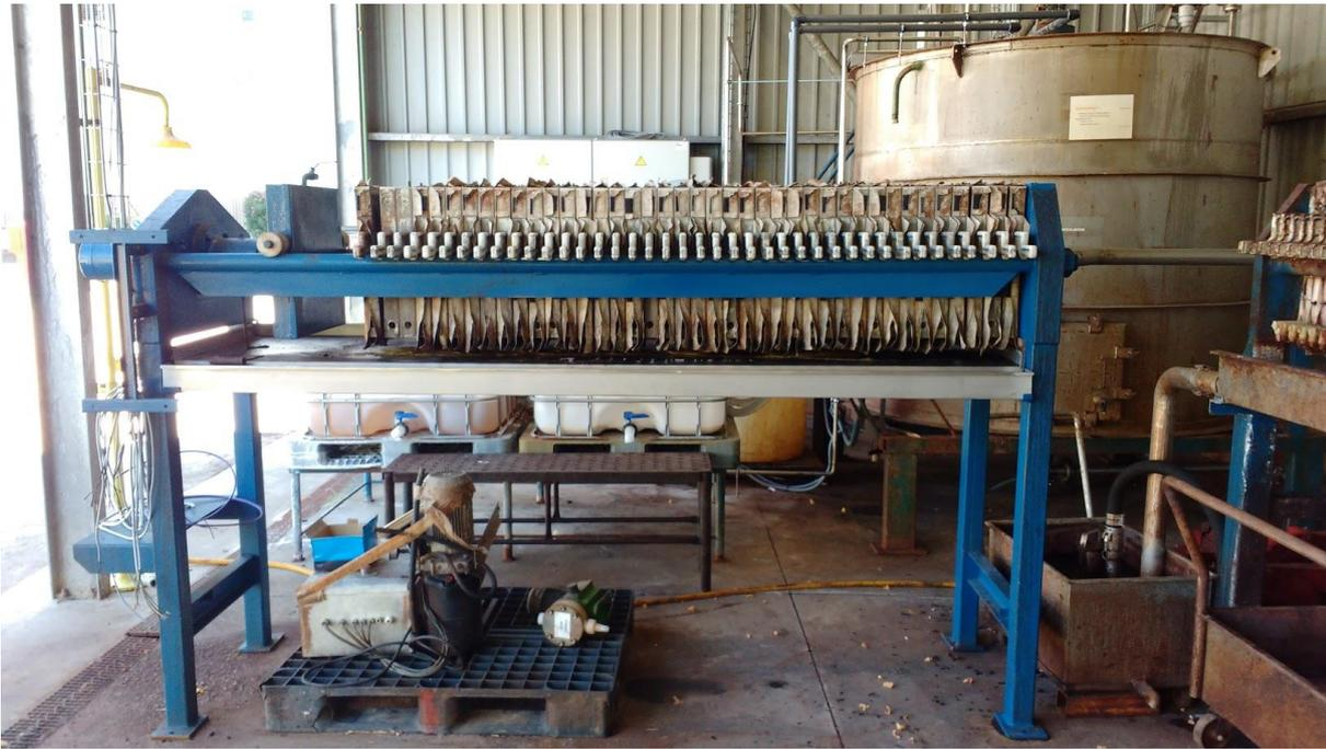
Figura 3.1 - Filtro Prensa inativo
