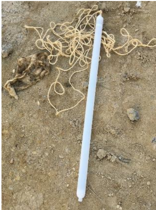
Figura 67 – amostrador de água vertical tipo Bailer (fonte: própria).
