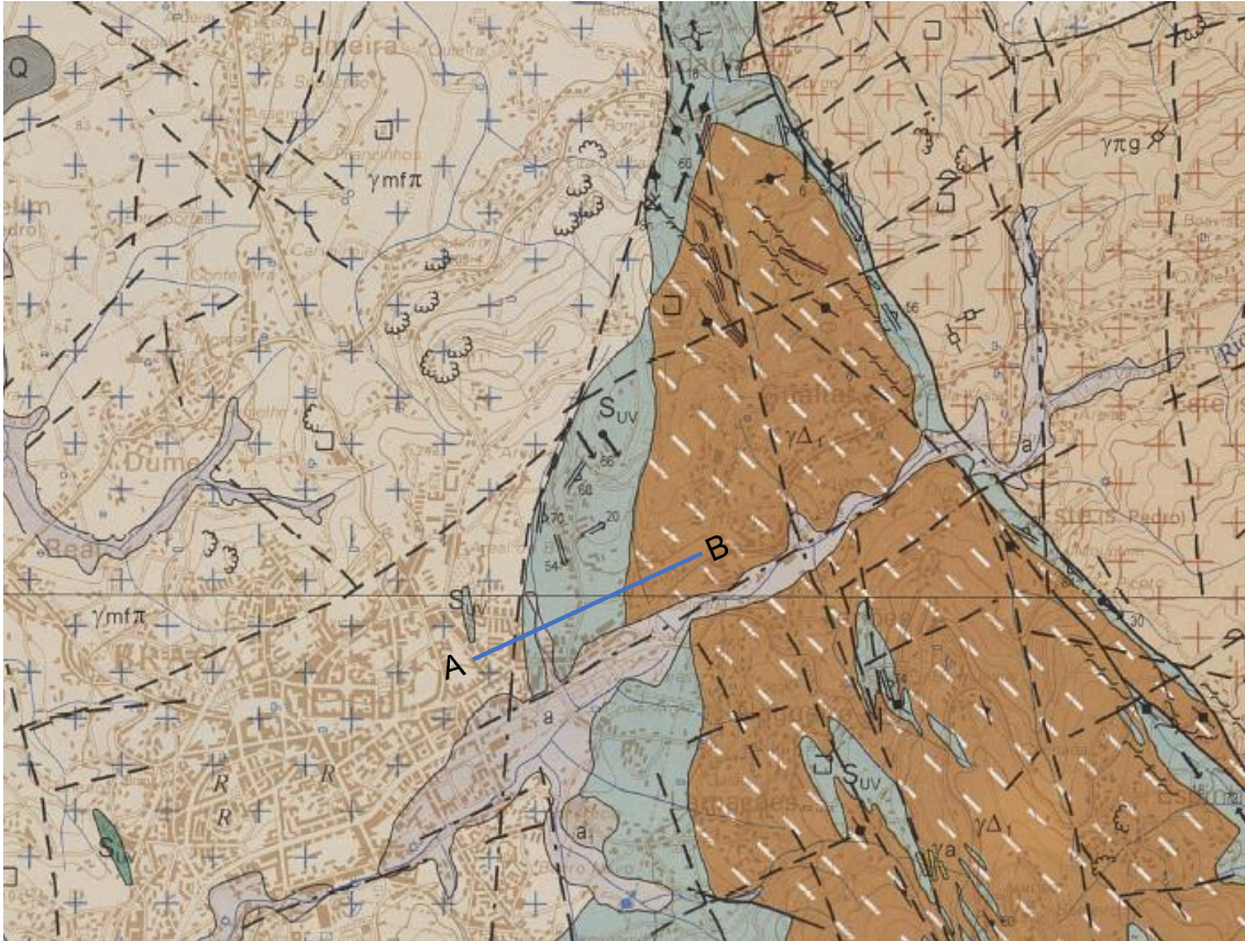
Figura 72 - Excerto da Carta Geológica 5D-Braga 1:50000, com "corte" que deu origem ao Modelo Hidrogeológico Regional Interpretativo.
