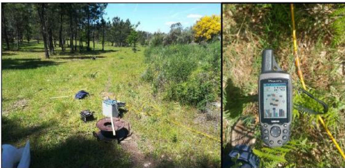
Figura 39 – Montagem de perfil elétrico e leitura de coordenadas GPS (fonte: própria).
