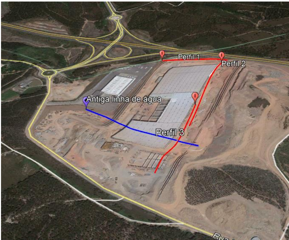
Figura 35 - Imagem Google Earth onde se assinala uma antiga linha de água bem como o local de execução dos perfis geolétricos (retirado de Google Earth).
