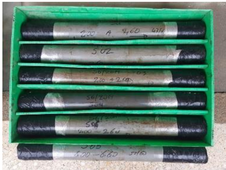
Figura 63 – Amostras inalteradas, recolhidas no amostrador tripartido, devidamente etiquetadas e acondicionadas (fonte: própria).
