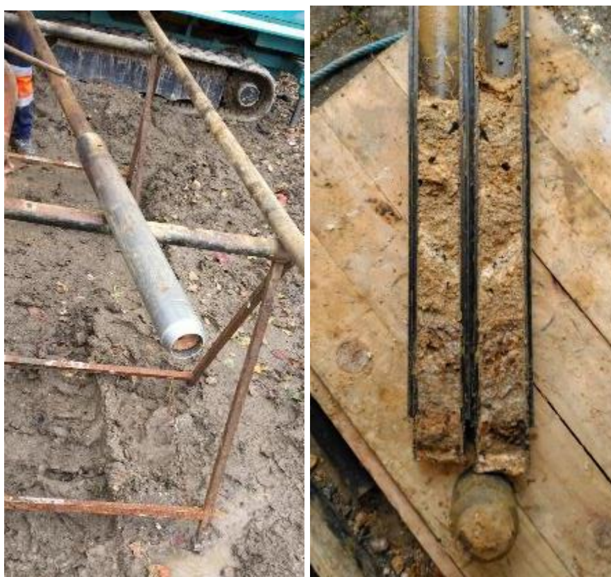
Figura 23 – Amostrador de Terzaghi (fonte: própria).
