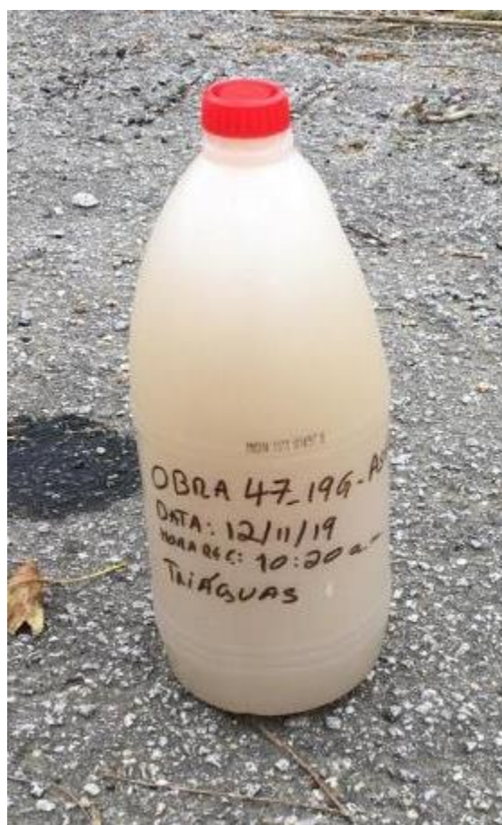
Figura 30 – Amostra de água devidamente acondicionada e etiquetada (fonte: própria).
