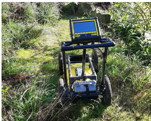
Figura 71 – Recolha de dados, visivelmente condicionada pela forte presença de vegetação (fonte: própria).
