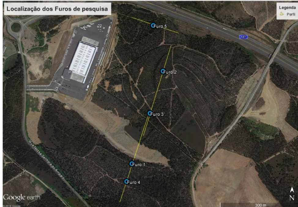
Figura 47 – Locais para possível realização da captação de água com base nos perfis geoelectricos 1, 2 e 3 (fonte: Google Earth).
