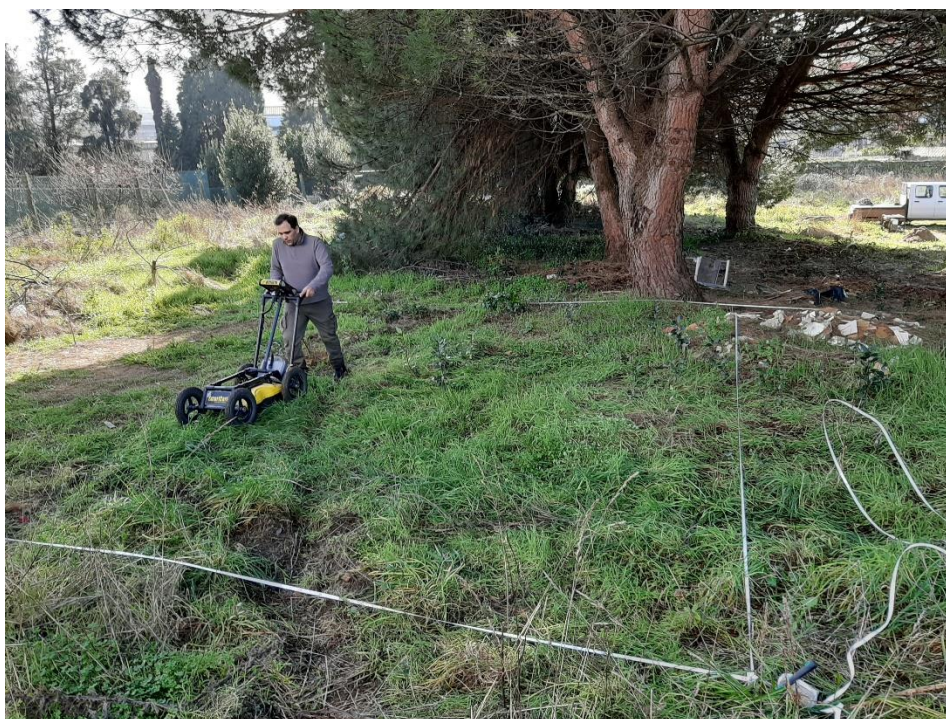
Figura 70 – Malha retangular estabelecida para recolha de perfis GPR (fonte: própria).
