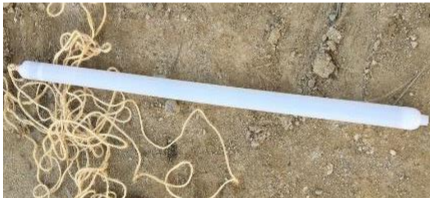
Figura 29 – Amostrador de água subterrânea tipo Bailer (fonte: própria).
