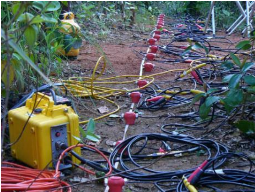
Figura 9 – Sismógrafo e geofones (Fonte:alphageofisica.com).
