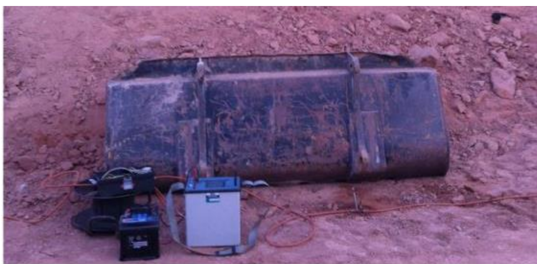
Figura 40 – Resistímetro utilizado na execução da tomografia elétrica de superfície (fonte: própria).
