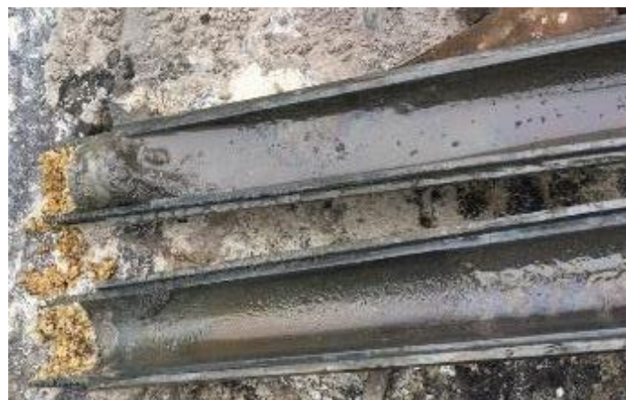
Figura 64 – Amostrador do tipo “Terzaghi” (fonte: própria).
