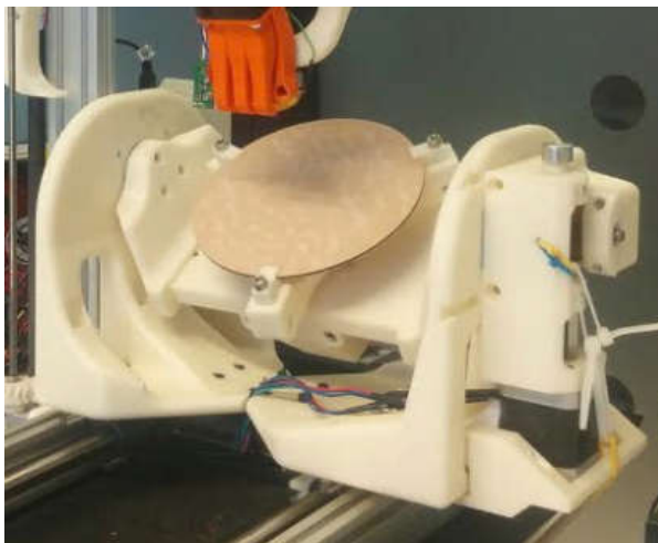
Figura 22 – Solução de base rotativa com 2 eixos angulares desenvolvida por Grutle [10].
