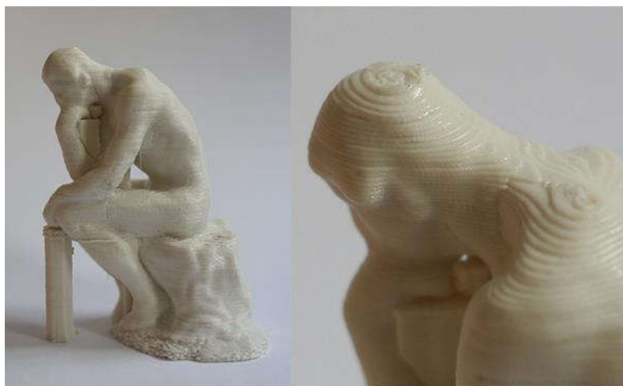
Figura 4 - Efeito de steeping numa impressão com FDM [9].
